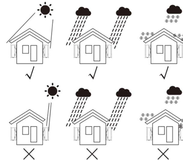
Figura 5.1 Ubicaciones de instalación recomendadas
